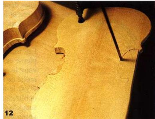
Il découpe ensuite la forme de la table d'harmonie et de la table du fond. A l'aide de rabots et de gouges, il se met à les creuser et à les tailler afin d'obtenir les épaisseurs nécessaires à un bon rendu de son. Ce travail est long et doit être méticuleux. La beauté de la forme de l'instrument et le son qu'il rendra en dépendent.
